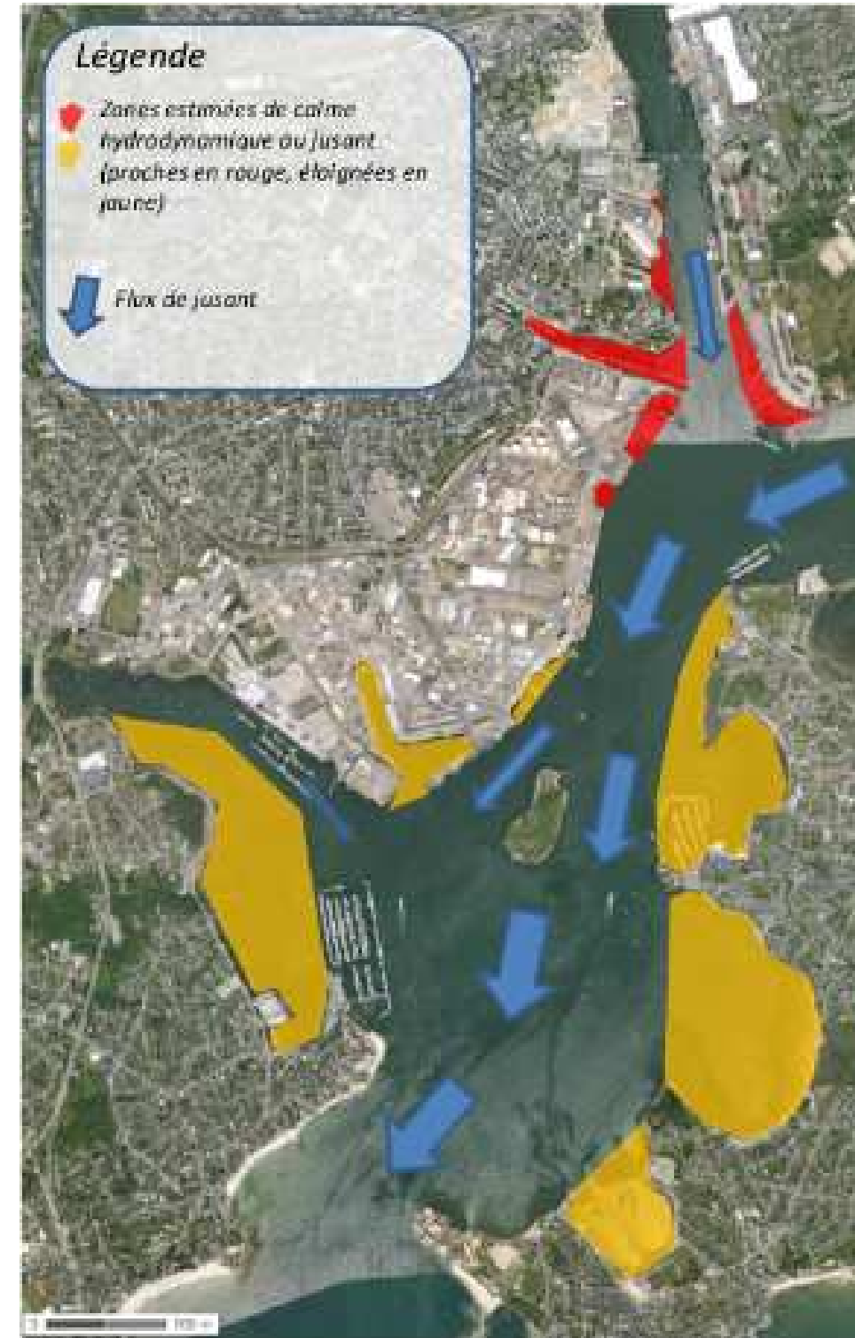
FIGURE 87 - LOCALISATION DES ZONES D'ACCRETIONS PRIVILEGIEES A L'ECHELLE DE LA RADE DE LORIENT (SOURCE : ETUDE DES SYSTEMES DE MISE EN SUSPENSION DES SEDIMENTS, IDRA ENVIRONNEMENT, 2013)
