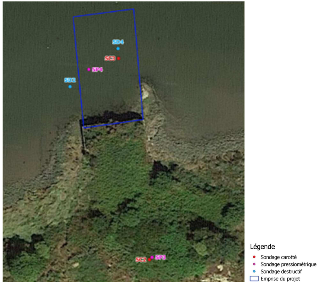
FIGURE 62 - PLAN D'IMPLANTATION DES SONDAGES (SOURCE : GEOTEC, 2018)
